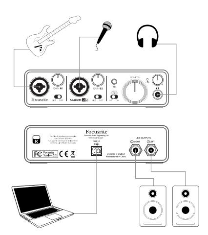
Esta configuración típica muestra las conexiones para grabar con la aplicación DAW en su Mac o PC. En este caso, es posible grabar en Ableton Live Lite la guitarra a través de la entrada 1 y la voz a través de la entrada 2 mientras monitoriza la reproducción desde la aplicación DAW a través de auriculares o altavoces.
