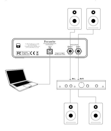
Todos los jacks de salida de línea son TRS de ¼" (6,35 mm) balanceados electrónicamente. Los amplificadores típicos (Hi-Fi) y pequeños monitores activos poseen entradas no balanceadas, por medio de conectores phono (RCA) o por medio de jacks estéreo de 3.5 mm, destinadas a su conexión directa en una computadora. En cualquier caso, utilice un cable de conexión adecuado con los conectores plug en un extremo.
