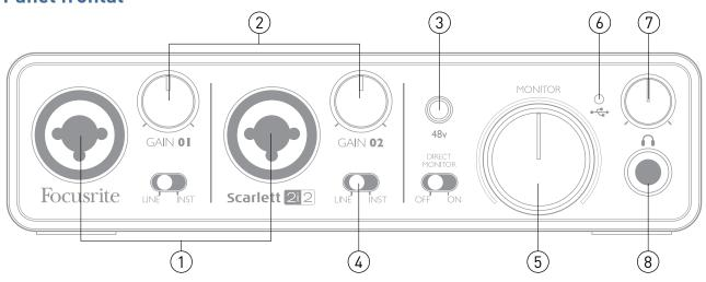
El panel frontal incluye conectores de entrada para señales de micrófono, línea e instrumentos, un conector para auriculares y controles de ganancia de entrada y monitorización.
